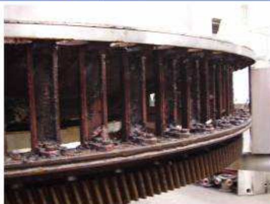
Наполнитель Veral 64 перед ремонтом (год выпуска 1997) – поворотный стол
