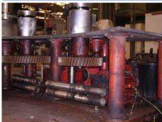
Наполнитель Veral 64 перед ремонтом (год выпуска 1997) – привод механизма
