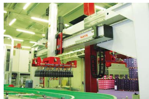
Vkladač lahví – manipulátor s dvouosým lineárním vedením GÜDEL
