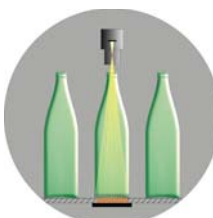
Kontrola zbytkové kapaliny infračervenou metodou
