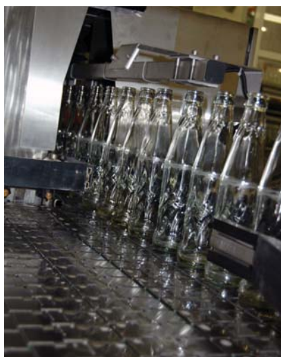
Automatické vyřazování nevyhovujících lahví na konci stroje.
