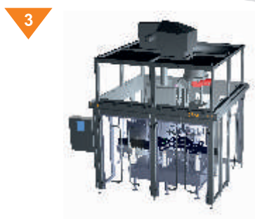
3 Dodávka plniče VERAL 44/9, aplikace metody hladinového přetlakové plnění s elektronickým ovládním
