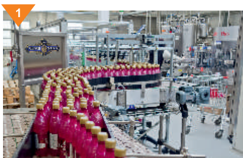
1 Dodávka kompletní plnicí linky s kapacitou 4200 1,0l skleněných lahví za hodinu pro plnění minerální vody
