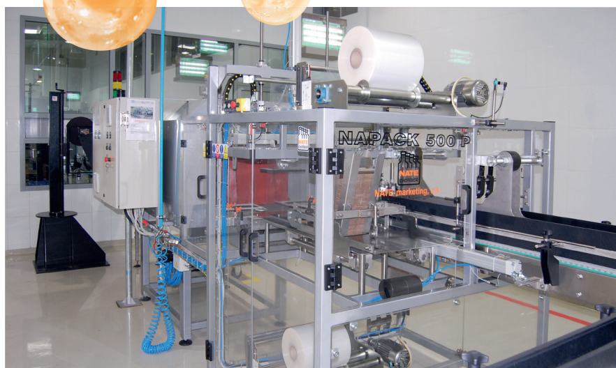
Automatická balící linka NAPACK 500 v provozu Al Ain, SAE
