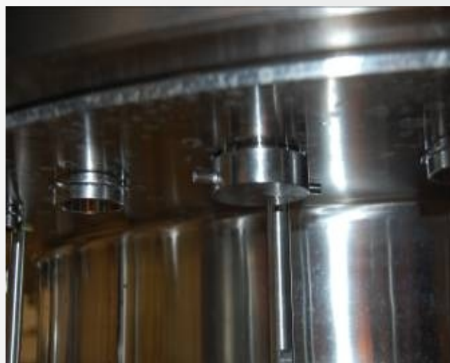
Клапан для розлива с надетой санитарной насадкой
