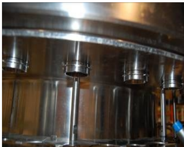
Клапан для розлива перед надеванием санитарной насадки
