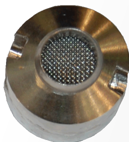
Наконечник, использующийся при розливе молока
