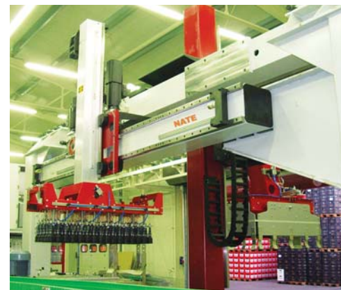
Загрузчик бутылок – манипулятор с двухосной линейной направляющей GÜDEL.
