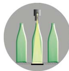
Контроль остатков жидкости инфракрасным методом
