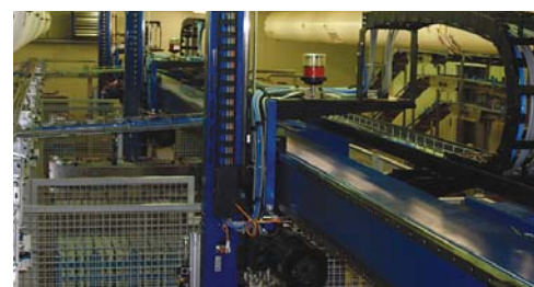
Палетизация блоков, производительность 1500 блоков/час.
