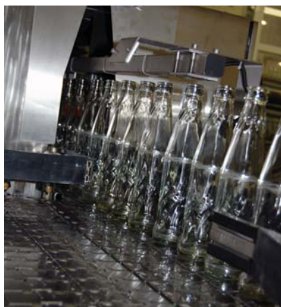
Автоматическая выбраковка дефектных бутылок на конце машины .
