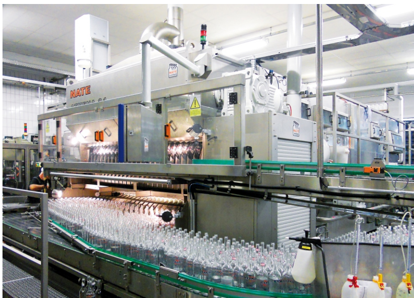
Bottle washer ATHENA 24/22.3 RHODIUS Mineralquelle und Getränke GmbH & Co.KG, Germany
