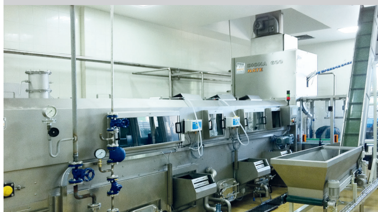
Моечная и разливочная машина сосудов 19 л в цехе Оболонь
