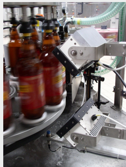
Exan Label CCD (Kontrolle der Etikettenanwesenheit - Einbau in Etikettiereinrichtung)
