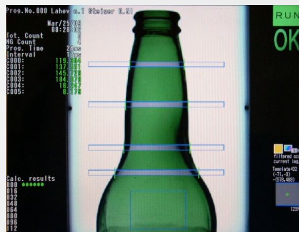
Monitor der Einrichtung Exan Sort CCD (Kontrolle der Form und der Farbe der Flasche)
