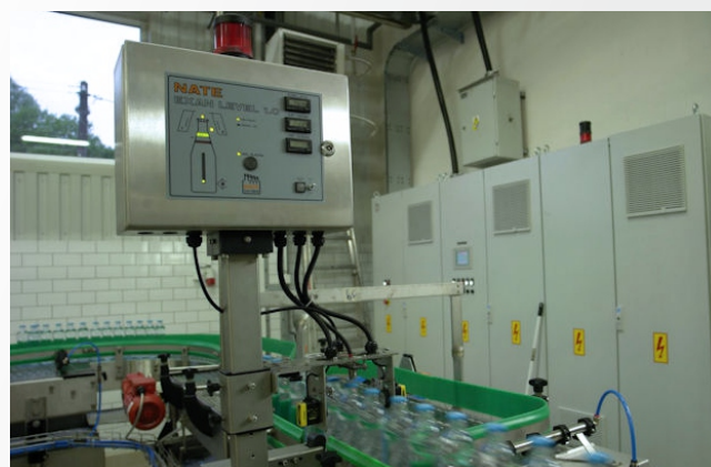
Exan Level (Kontrolle der Getränkefüllhöhe und Anwesenheit des Verschlusses hinter dem Füller)
