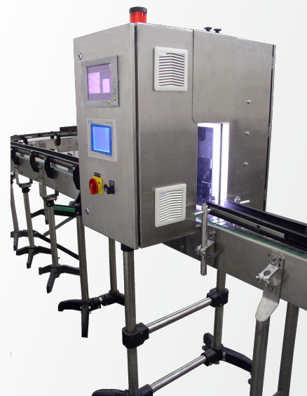
Exan View (Kontrolle der Füllhöhe, des Verschlusses und des Etiketts bei PET-Flaschen)
