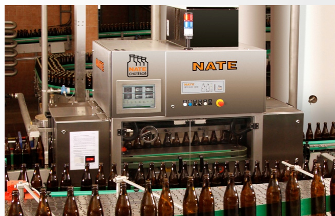
Exan 08 CCD (komplette Kontrolle der leeren Flaschen vor dem Füllen)
