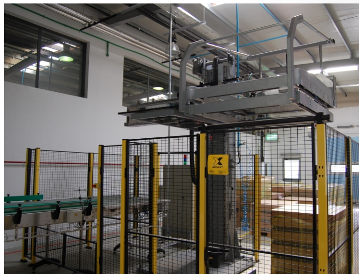
NMD 1000 P - центрирующая и сдвижная рама
