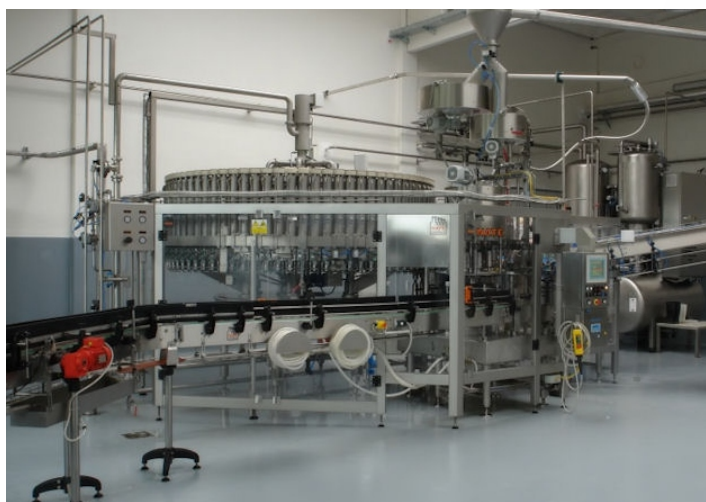
Plnič před úpravou krytování - Veseta s.r.o. Litovel, Česká republika
